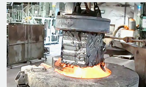
鋳造用溶解炉への材料投入の様子
