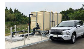
プラグインハイブリッド車からの給電試験の様子
