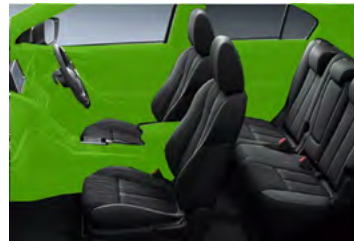
『エクリプス クロス』における「熱可塑性樹脂」の主な採用箇所(グリーン部) (上:エクステリア、下:インテリア)
