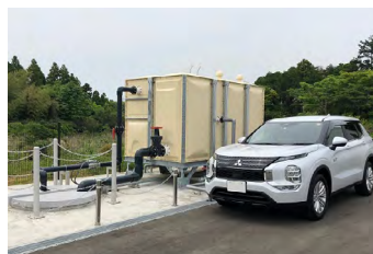
プラグインハイブリッド車からの給電試験の様子
